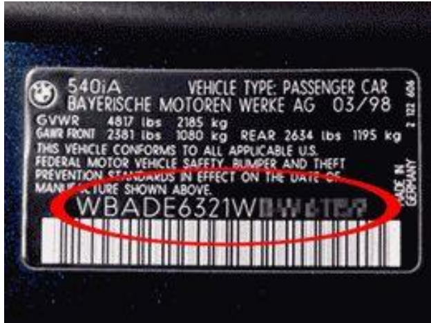
Рисунок 1: Пример нанесения VIN на заводской табличке
