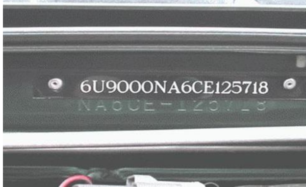
Рисунок 2: Пример нанесения VIN на инструментальной панели (передней панели со стороны моторного отсека) автомобиля
