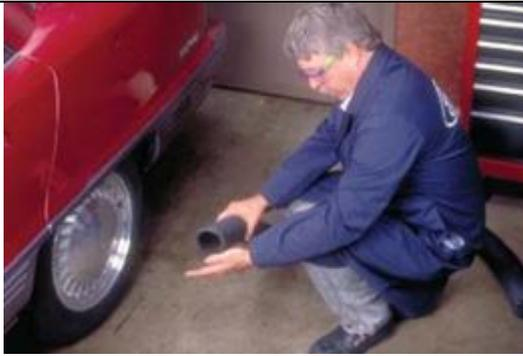
Рисунок N/A 025-1: Проверьте дееспособность системы вентиляции выхлопных газов перед её подключением к автомобилю. Включите электромотор вентилятора, и приложите ладонь к заборной части шланга
