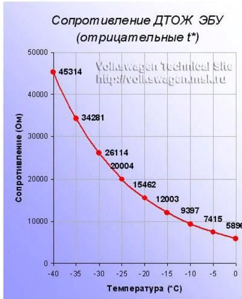
Рисунок NA039-5: Графическая зависимость сопротивления датчика температуры охлаждающей жидкости от её температуры.
