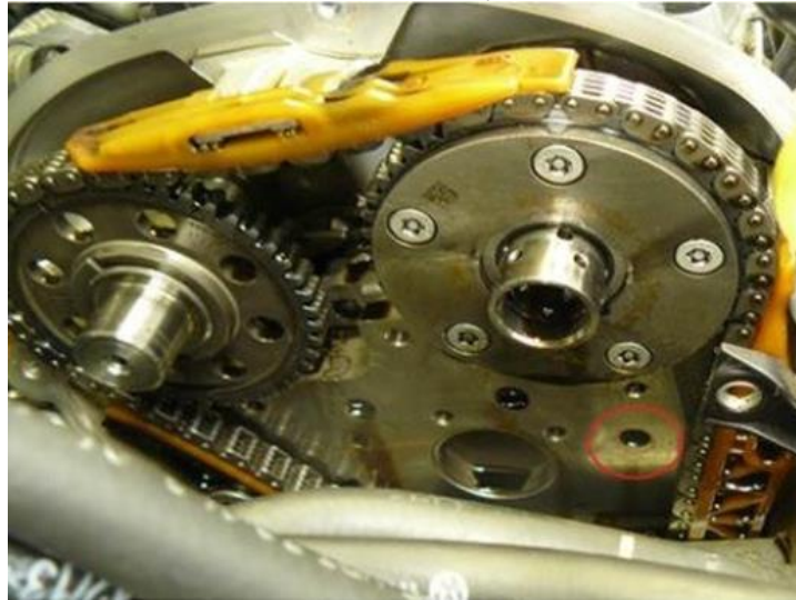
Рисунок NA 040-8: Место проверки масляного канала (красный круг) под обратный клапан в головке блока цилиндров
