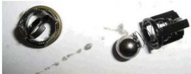
Рисунок NA 040-7: Обратный клапан из пластика
