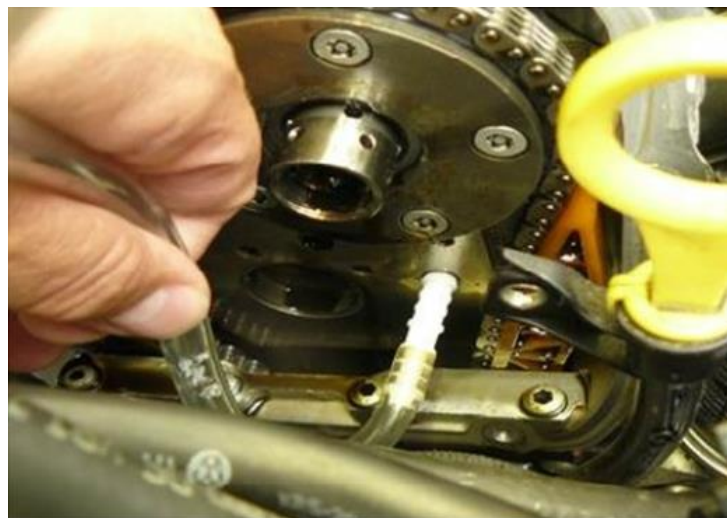
Рисунок NA 040-9: Плотно прижать напорную магистраль с адаптером VAS 6213, вставленным в отверстие масляного канала
