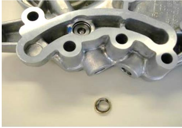
Рисунок NA 040-6: Стойка подшипника с обратным клапаном из металла (со снятой сеткой)
